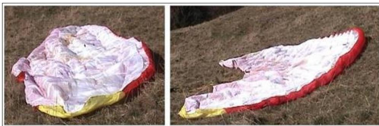
Figure P7 : Disposition de la voile déployée. A gauche voile rectiligne, peu favorable. A droite, voile en arc de cercle, favorable.
