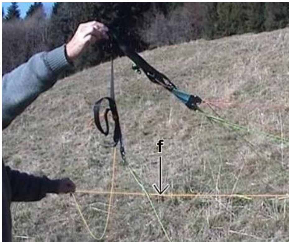
Figure P8 : Démêlage des suspentes de frein (f), bien latéralement.
