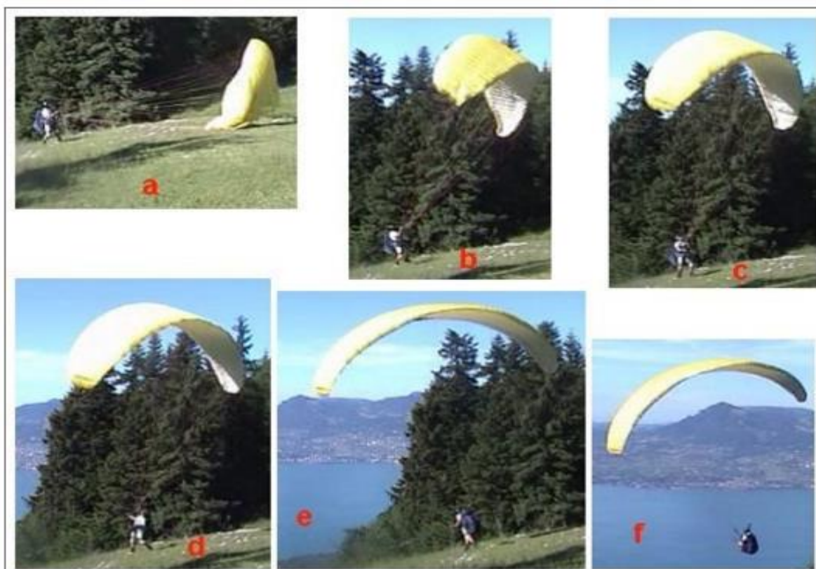
Figure P13 : Décollage face à la voile. Le pilote gonfle (a), lève (b) et contrôle (c) la calotte, dos à la trajectoire de décollage et avec délicatesse. A la fin du contrôle, il se tourne (d) du bon côté, ici à droite, temporise une fraction de seconde pour jeter un dernier coup d'œil sur l'espace aérien puis accélère (e), penché en avant. Une fois éloigné du relief, il s'installe enfin dans la sellette (f).
